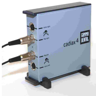
Il dispositivo CADIAX 4 con il set di sensori "compact", che occupa solo i due connettori centrali del dispositivo.
