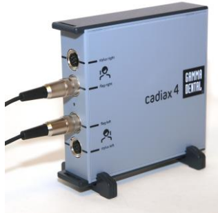
El dispositivo CADIAX 4 con el conjunto de sensores "compacto" conectado, que ocupa solo los dos conectores centrales del dispositivo.
