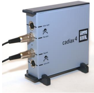
El dispositivo CADIAX 4 con el conjunto de sensores "compacto" conectado, que ocupa solo los dos conectores centrales del dispositivo.
