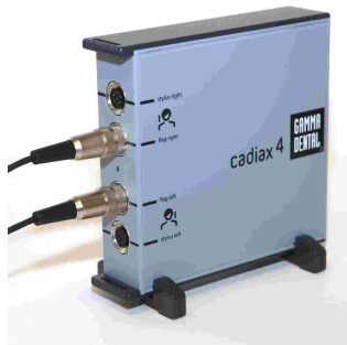
Das CADIAX 4-Gerät mit "compact"-Sensorik, welche über die mittleren zwei Stecker des Geräts verbunden wird.
