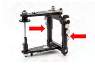
Holme durch Erwärmen lösen und reinigen
