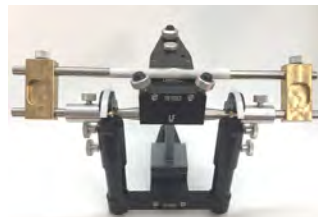
Holme mit Justagekleber verbinden und mit Justagehilfe und Justier-Prüf Schlüssel neu ausrichten
