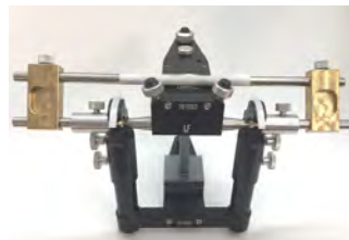
Holme mit Justagekleber verbinden und mit Justagehilfe und Justier-Prüf Schlüssel neu ausrichten
