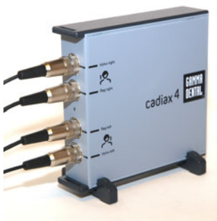
Das CADIAX 4-Gerät mit "diagnostic"-Sensorik, welche über alle vier Stecker des Geräts verbunden wird.
